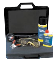
Kit detectie scurgeri cu Lampa UV, Ochelari si solutii 007935090120 KITUL CU LAMPĂ DE LA MAGNETI MARELLI PERMITE DETECTAREA RAPIDĂ A SCURGERILOR DIN SISTEMELE DE AER CONDIȚIONAT ALE MAȘINILOR • o lampă UV 50 W cu vârf rotativ • ulei (PAG) cu agent de contrast • ochelari de protecție • spray pentru eliminarea agenților
