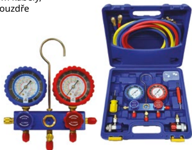
Sada tlakoměrů pro faktor 1234yf (stupnice R1234a, R1234yf, R32, R4110A), hadice 2,5 m, rychlospojky R1234yf, klíč v kufru 007950024725
